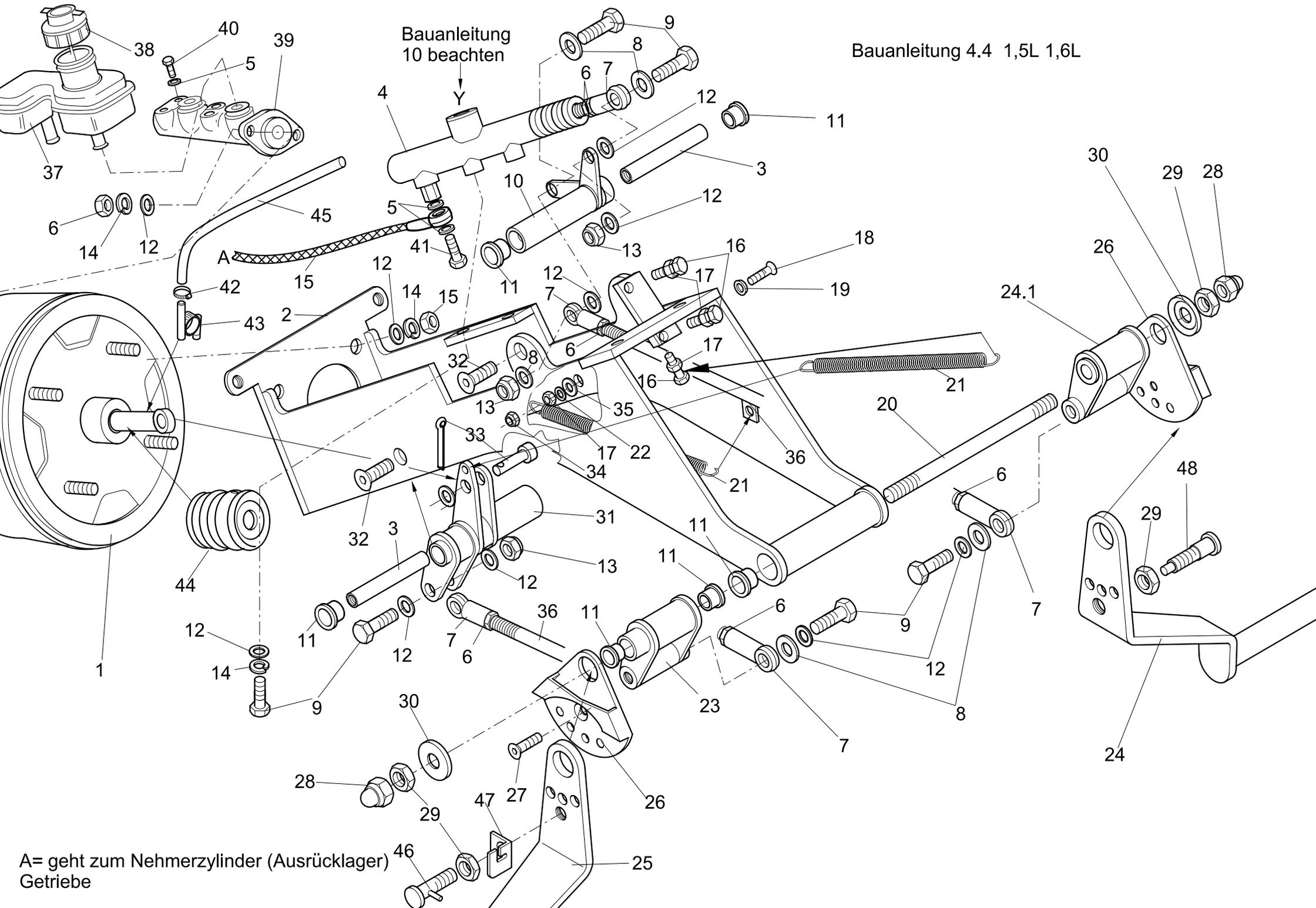
A= geht zum Nehmerzylinder (Ausrücklager) Getriebe
