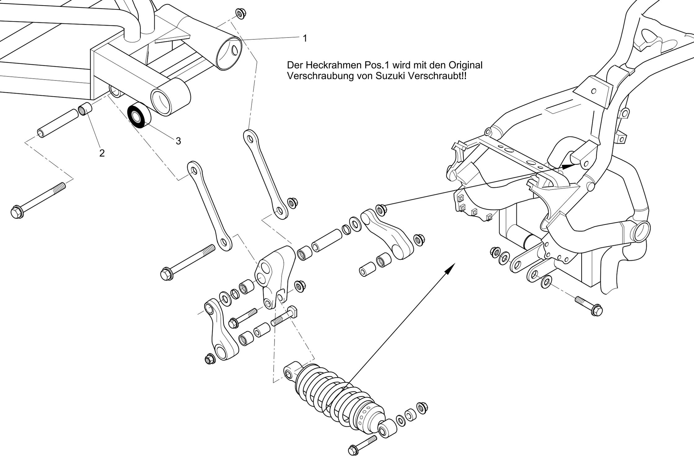
Der Heckrahmen Pos.1 wird mit den Original Verschraubung von Suzuki Verschraubt!!
