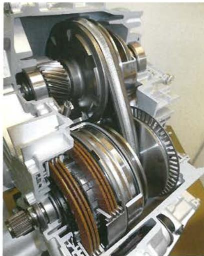
**Stufenlose Stufung:** Das CVT-Getriebe schaltet blitzschnell durch sieben »virtuelle« Gänge, die Sport-Stufe erlaubt dem Fahrer eine manuelle Gangwahl. Der 1500er-Mitsubishi-Vierzylinder ist per Turbo und Ladeluftkühler auf 140 PS gedopt. Jede Menge Edelstahl und Chrom funkeln um die Wette, kleine Zusatzspiegel halten die Kotflügel im Blick. Der Kofferraum fasst tourentaugliche 180 Liter (v. l. o. n. r. u.).
