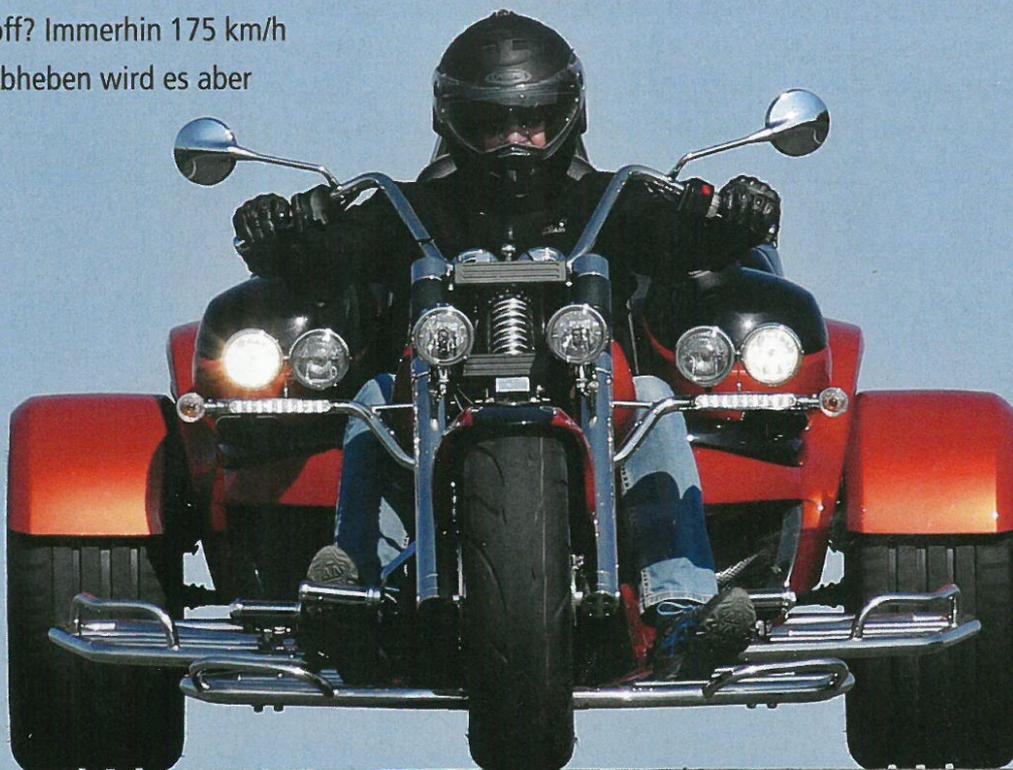
ge drin, das tatsächlich den Komfort erhöht. Dazu wurde ein neuer Rahmen entwickelt, der dem Fahrer und Beifahrer mehr Bewegungsfreiheit ermöglicht. Auch die Gabel wurde völlig neu gestaltet. Der Lenkkopfwinkel ist wesentlich steiler, der Lenker ist für unterschiedlichste Armlängen gut erreichbar. Wer sich für dieses Paket entscheidet, erhält ein adaptives Fahrwerk mit einstellbaren Gasdruckdämpfern. Ein klappbarer Fahrersitz erleichtert den Zugang für den Passagier und auch den Zugriff auf
