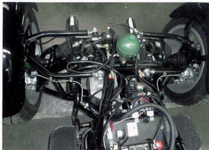
Die ausgeklügelte Hydropneumatik des Rewaco-Trikes verleiht der Fuhre höchsten Fahrkomfort und hält es auch in schnellen Kurven in der Waage.
