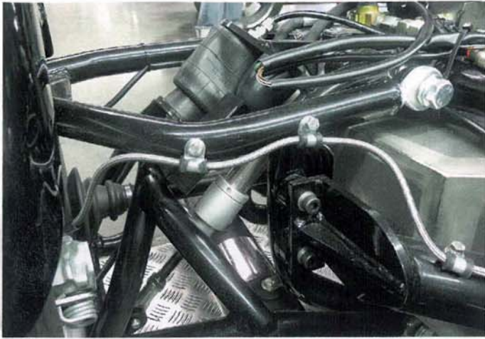
An der Radaufhängung sind zwei spezielle hydraulische Dämpferelemente sichtbar, die ihre Arbeitsbefehle über eine raffinierte Elektronik erhalten.
